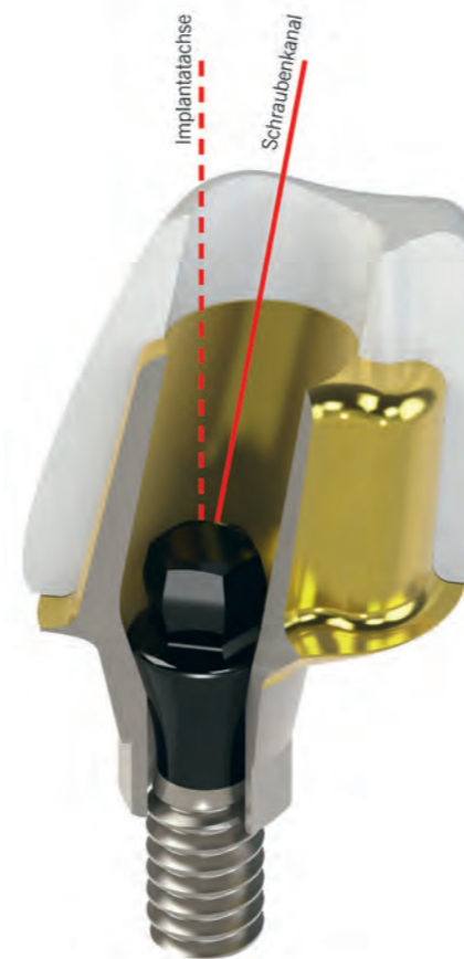
Abbildung 8: Ein anatomisch optimiertes Abutment wird auf Implantatschulterniveau verschraubt.
